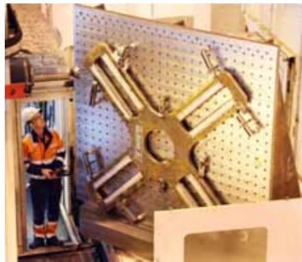
STORT: Maskinverkstedet på Karmøy maskinerer alt fra smådeler som går i mindre dreiebenker og fresemaskiner, til større, tyngre deler og utstyr som løftes inn med traverskran på 15 tonn. Verkstedet har HNK boreverk og dreiebenker som tar opptil 20 tonn og en diameter på 1600 mm.
